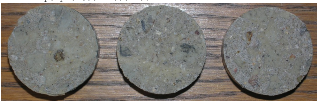
Obr.F41-211 Zkušební terče číslo 57, 107, 119 (zkušební místo 11) po provedení odtrhu.
