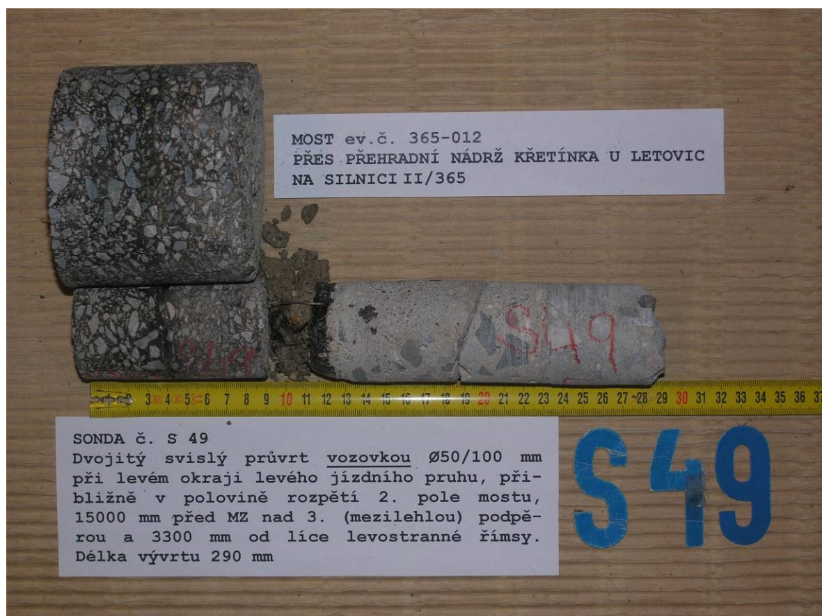
Obr.F41-149 Sonda S49. Dvojitý svislý průvrt Ø 50/100 mm vozovkou při levém okraji levého jízdního pruhu, přibližně v polovině rozpětí 2. pole mostu, 15000 mm před MZ nad 3. (mezilehlou) podpěrou a 3300 mm od líce levostranné římsy. Délka vývrtu 290 mm.
