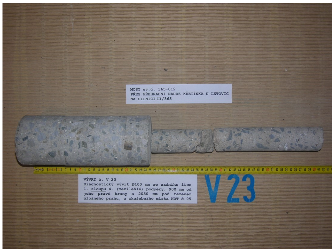
Obr. F41-23 VÝVRT č. V23. Diagnostický vývrt \varnothing 100 mm ze zadního líce 1. sloupu 4. (mezilehlé) podpěry, 900 mm od jeho pravé hrany a 2050 mm pod temenem úložného prahu. U zkušebního místa NDT (Schmidt) č.95.
