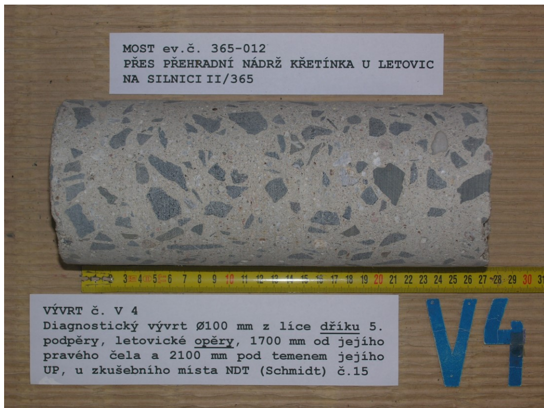
Obr. F41-04 VÝVRT č. V4. Diagnostický vývrt \varnothing 100 mm z líce dříku 5. podpěry, letovické opěry, 1700 mm od jejího pravého čela a 2100 mm pod temenem jejího UP. U zkušebního místa NDT (Schmidt) č.15.
