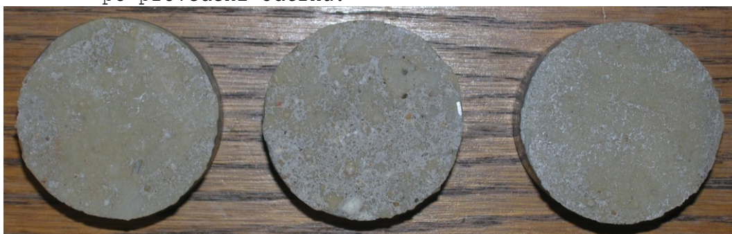
Obr.F41-210 Zkušební terče číslo 21, 109, 142 (zkušební místo 10) po provedení odtrhu.
