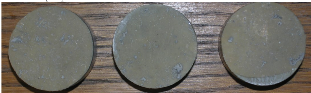
Obr.F41-215 Zkušební terče číslo 46, 131, 144 (zkušební místo 15) po provedení odtrhu.
