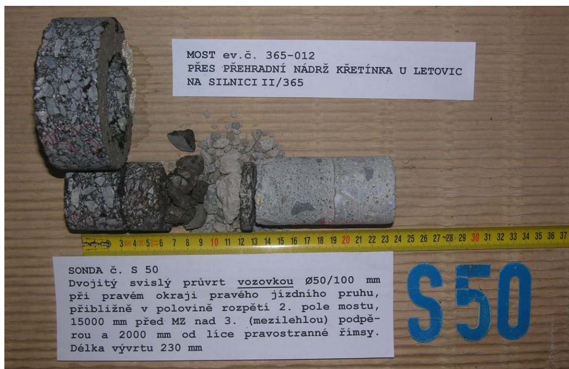
Obr.F41-150 Sonda S50. Dvojitý svislý průvrt \varnothing 50/100 mm vozovkou při pravém okraji pravého jízdního pruhu, přibližně v polovině rozpětí 2. pole mostu, 15000 mm před MZ nad 3. (mezilehlou) podpěrou a 2000 mm od líce pravostranné římsy. Délka vývrtu 230 mm.
