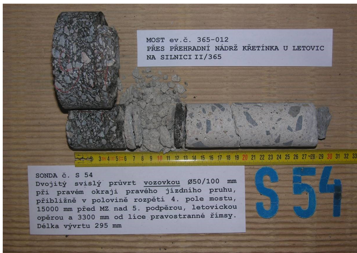
Obr.F41-154 Sonda S54. Dvojitý svislý průvrt \varnothing 50/100 mm vozovkou při pravém okraji pravého jízdního pruhu, přibližně v polovině rozpětí 4. pole mostu, 15000 mm před MZ nad 5. (mezilehlou) podpěrou a 3300 mm od líce pravostranné římsy. Délka vývrtu 295 mm.
