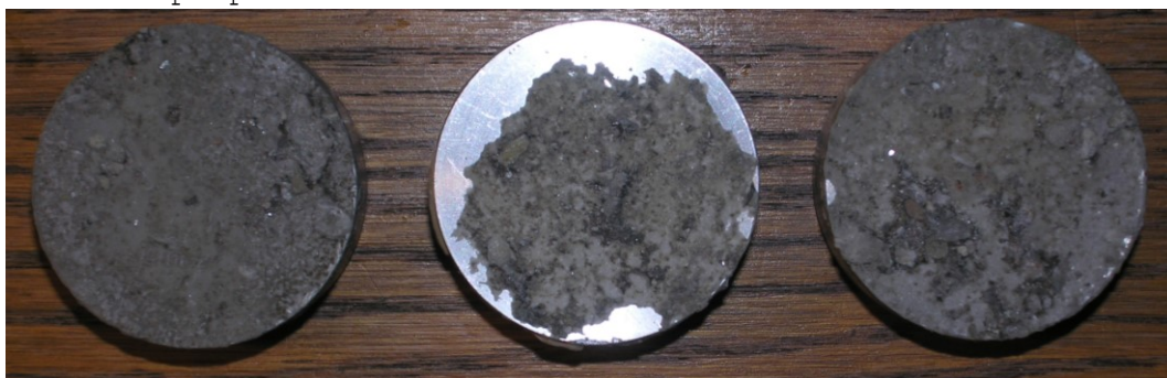
Obr.F41-214 Zkušební terče číslo 136, 159, 162 (zkušební místo 14) po provedení odtrhu.
