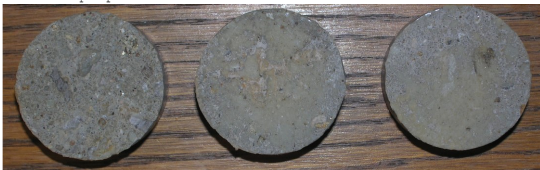
Obr.F41-212 Zkušební terče číslo 66, 91, 102 (zkušební místo 12) po provedení odtrhu.
