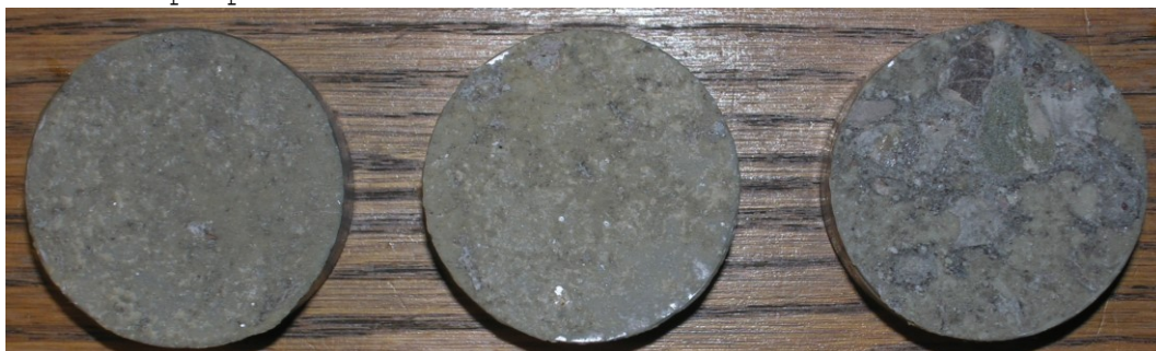
Obr.F41-216 Zkušební terče číslo 4, 115, 143 (zkušební místo 16) po provedení odtrhu.
