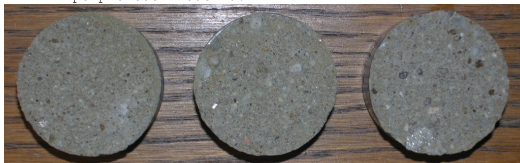
Obr.F41-220 Zkušební terče číslo 13, 18, 75 (zkušební místo 20) po provedení odtrhu.
