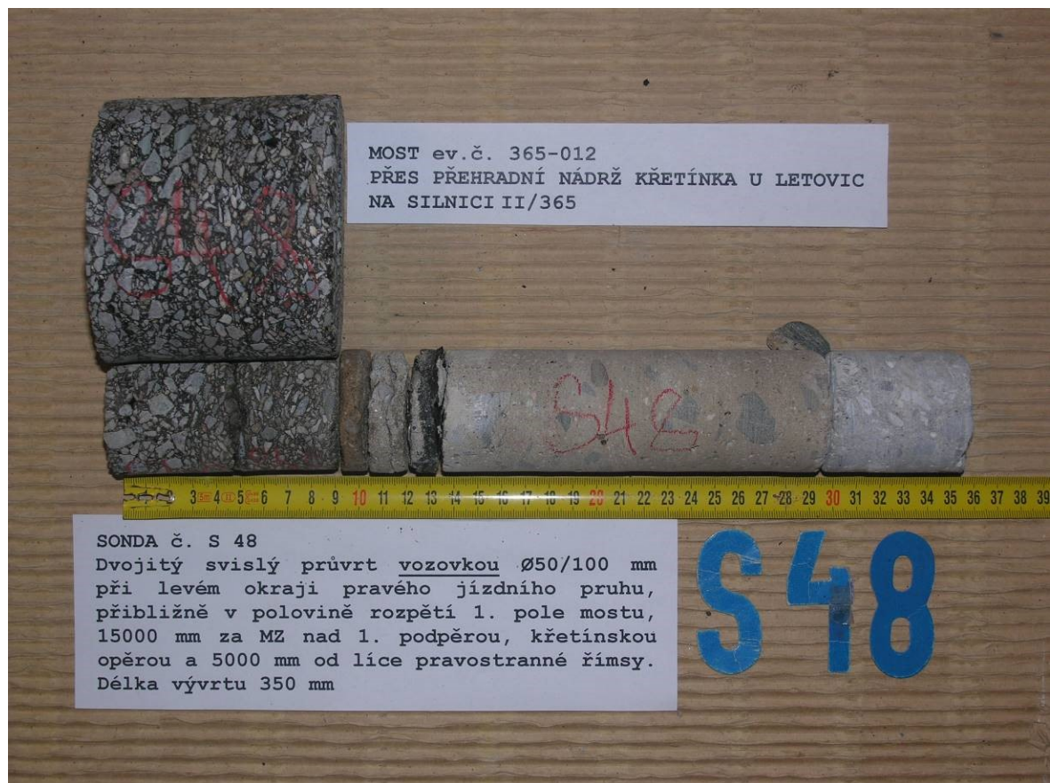
Obr.F41-148 Sonda S48. Dvojitý svislý průvrt \varnothing 50/100 mm vozovkou při levém okraji pravého jízdního pruhu, přibližně v polovině rozpětí 1. pole mostu, 15000 mm za MZ nad 1. podpěrrou, křetínskou opěrrou a 5000 mm od líce pravostranné římsy. Délka vývrtu 350 mm.
