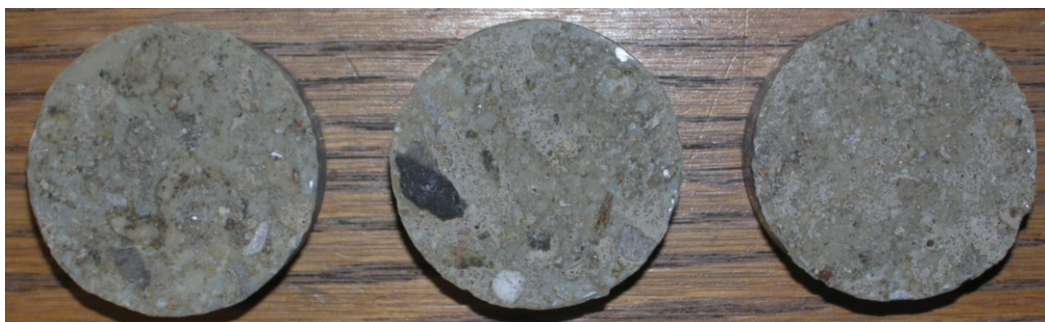
Obr.F41-208 Zkušební terče číslo 10, 106, 137 (zkušební místo 8) po provedení odtrhu.
