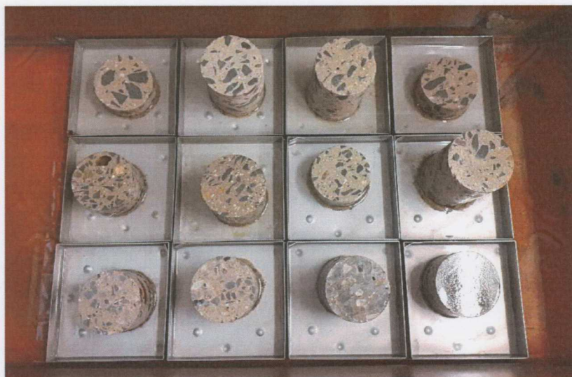
Obr. 1 Zkušební tělesa umístěná v zařízení KD-20 po prvních 25 cyklech
