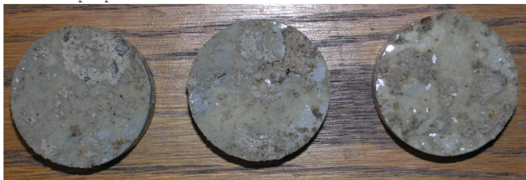
Obr.F41-202 Zkušební terče číslo 95, 135, 155 (zkušební místo 2) po provedení odtrhu.
