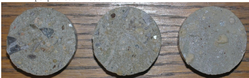
Obr.F41-209 Zkušební terče číslo 17, 40, 68 (zkušební místo 9) po provedení odtrhu.
