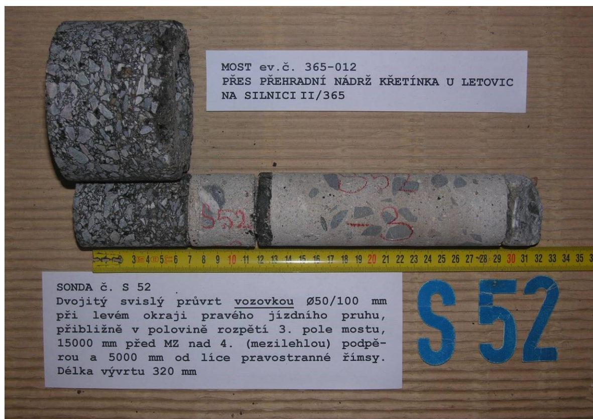
Obr.F41-152 Sonda S52. Dvojitý svislý průvrt Ø 50/100 mm vozovkou při levém okraji pravého jízdního pruhu, přibližně v polovině rozpětí 3. pole mostu, 15000 mm před MZ nad 4. (mezilehlou) podpěrou a 5000 mm od líce pravostranné římsy. Délka vývrtu 320 mm.
