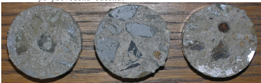
Obr.F41-204 Zkušební terče číslo 80, 20, 160 (zkušební místo 4) po provedení odtrhu.
