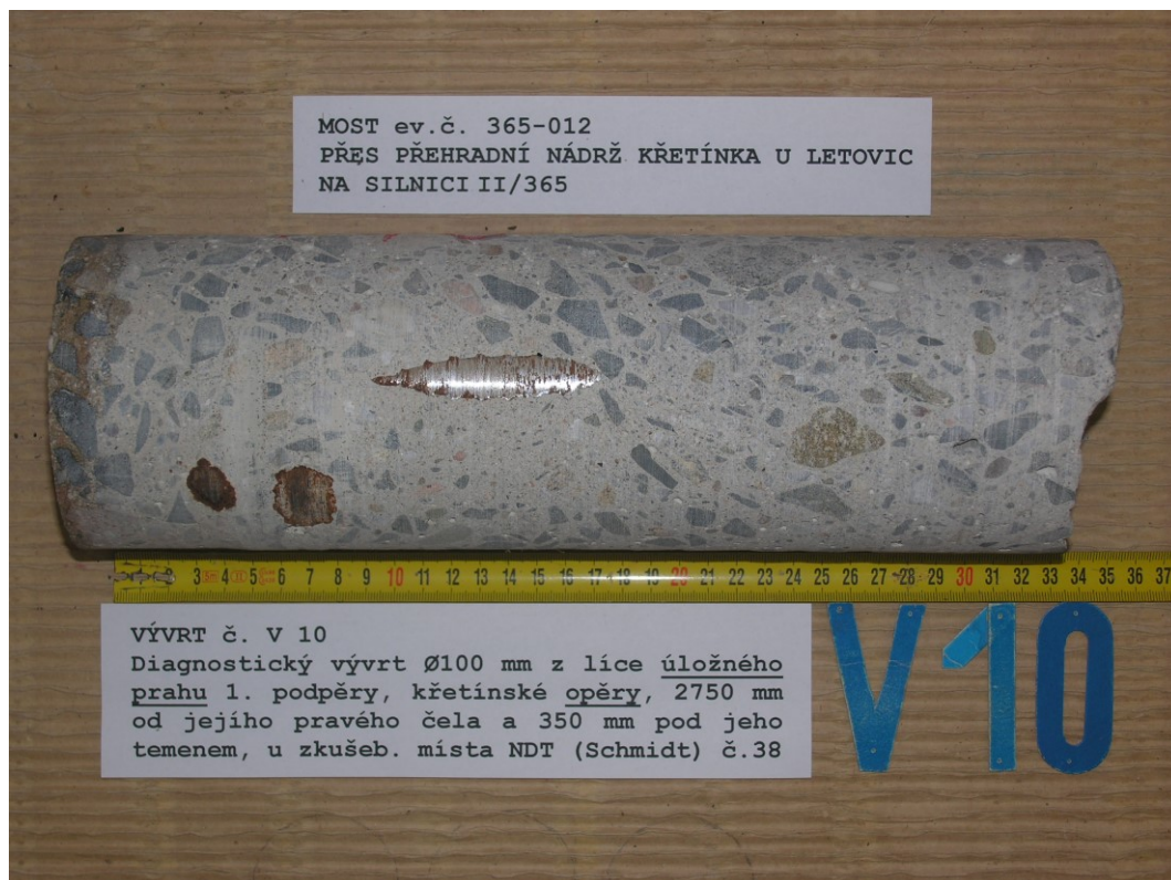
Obr. F41-10 VÝVRT č. V10. Diagnostický vývrt Ø100 mm z líce úložného prahu 1. podpěry, křetínské opěry , 2750 mm od jejího pravého čela a 350 mm pod jeho temenem. U zkušebního místa NDT (Schmidt) č.38.
