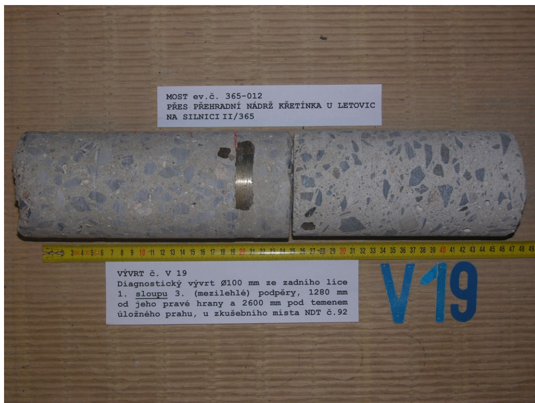
Obr. F41-19 VÝVRT č. V19. Diagnostický vývrt Ø100 mm ze zadního líce 1. sloupu 3. (mezilehlé) podpěry, 1280 mm od jeho pravé hrany a 2600 mm pod temenem úložného prahu. U zkušebního místa NDT (Schmidt) č.92.
