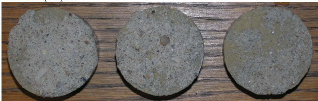
Obr.F41-219 Zkušební terče číslo 51, 73, 108 (zkušební místo 19) po provedení odtrhu.
