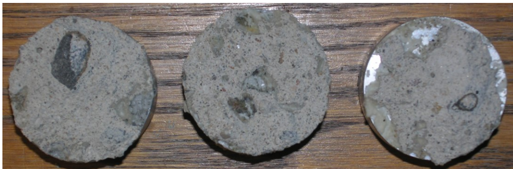
Obr.F41-201 Zkušební terče číslo 90, 121, 170 (zkušební místo 1) po provedení odtrhu.
