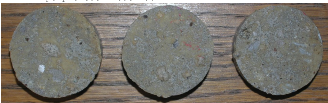
Obr.F41-207 Zkušební terče číslo 3, 39, 133 (zkušební místo 7) po provedení odtrhu.
