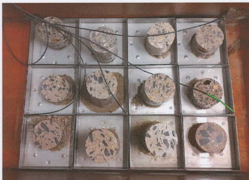
Obr. 2 Zkušební tělesa umístěná v zařízení KD-20 po druhých 25 cyklech
