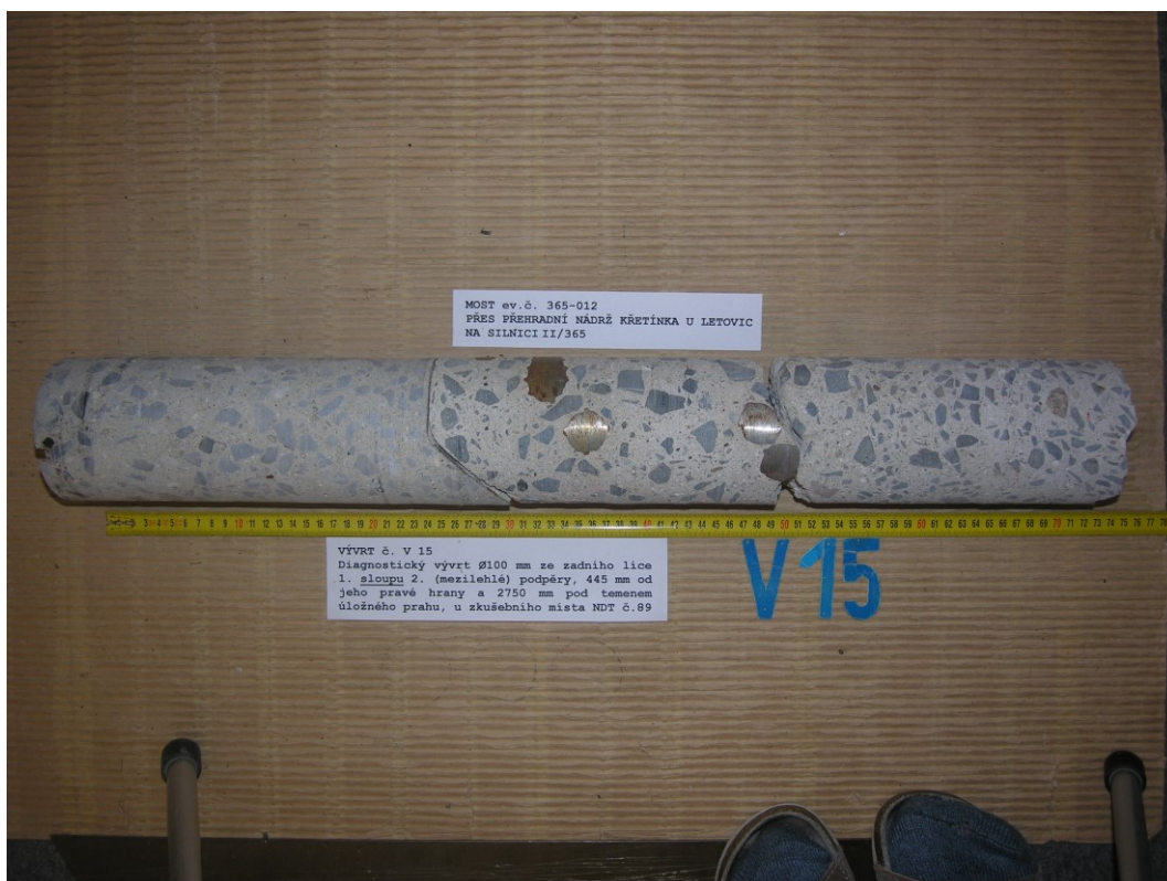
Obr. F41-15 VÝVRT č. V15. Diagnostický vývrt \varnothing 100 mm ze zadního líce 1. sloupu 2. (mezilehlé) podpěry, 445 mm od jeho pravé hrany a 2750 mm pod temenem úložného prahu. U zkušebního místa NDT (Schmidt) č.89.
