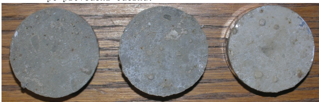
Obr.F41-205 Zkušební terče číslo 2, 6, 152 (zkušební místo 5) po provedení odtrhu.
