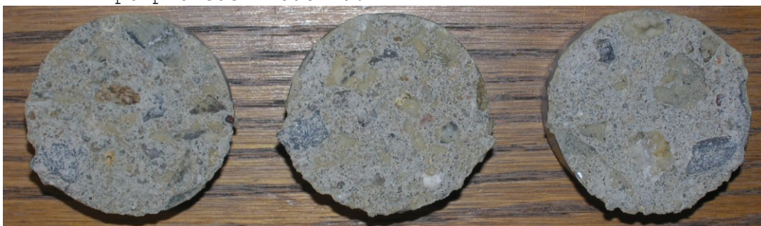
Obr.F41-206 Zkušební terče číslo 103, 54, 122 (zkušební místo 6) po provedení odtrhu.
