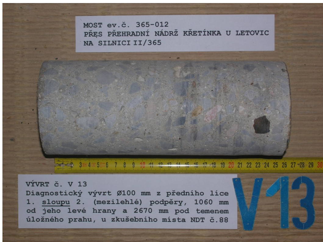
Obr. F41-13 VÝVRT č. V13. Diagnostický vývrt \varnothing 100 mm z předního líce 1. sloupu 2. (mezilehlé) podpěry, 1060 mm od jeho levé hrany a 2670 mm pod temenem úložného prahu. U zkušebního místa NDT (Schmidt) č.88.
