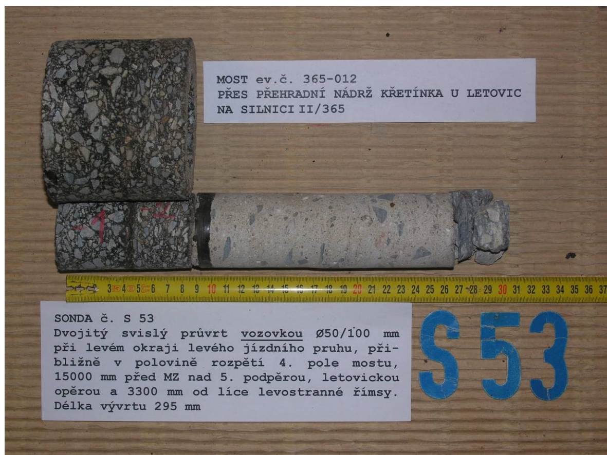
Obr.F41-153 Sonda S53. Dvojitý svislý průvrt \varnothing 50/100 mm vozovkou při levém okraji levého jízdního pruhu, přibližně v polovině rozpětí 4. pole mostu, 15000 mm před MZ nad 5. (mezilehlou) podpěrrou a 3300 mm od líce levostranné římsy. Délka vývrtu 295 mm.
