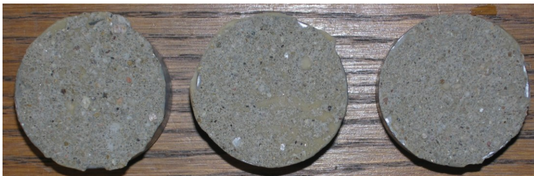
Obr.F41-218 Zkušební terče číslo 8, 71, 105 (zkušební místo 18) po provedení odtrhu.
