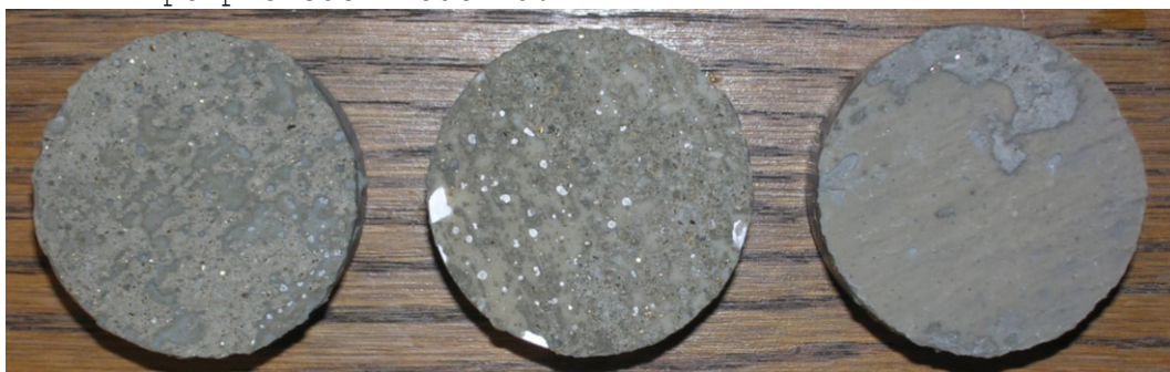
Obr.F41-217 Zkušební terče číslo 78, 157, 81 (zkušební místo 17) po provedení odtrhu.
