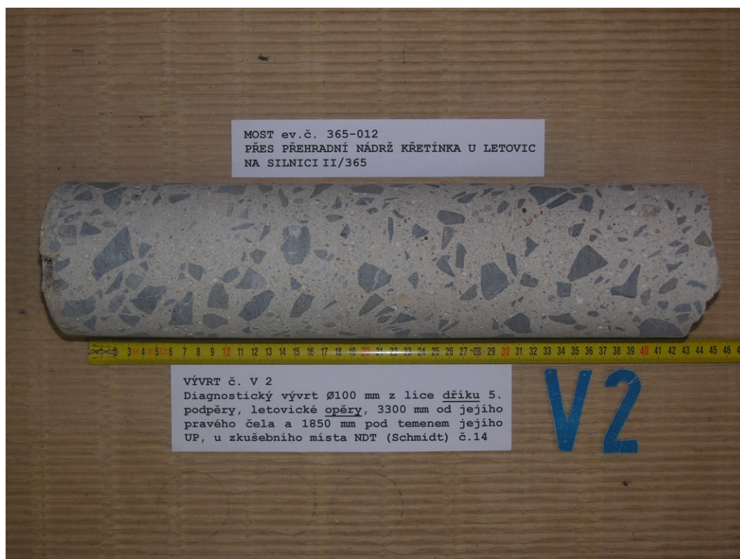
Obr. F41-02 VÝVRT č. V2. Diagnostický vývrt \varnothing 100 mm z líce dříku 5. podpěry, letovické opěry, 3300 mm od jejího pravého čela a 1850 mm pod temenem jejího UP. U zkušebního místa NDT (Schmidt) č.14.
