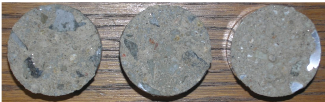
Obr.F41-203 Zkušební terče číslo 1, 19, 151 (zkušební místo 3) po provedení odtrhu.
