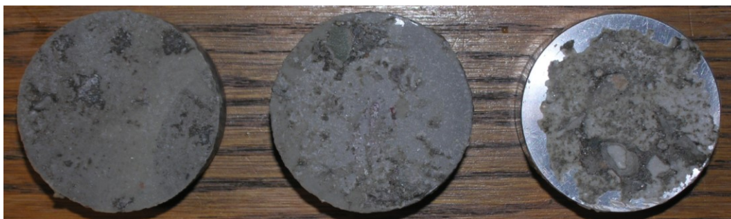
Obr.F41-213 Zkušební terče číslo 7, 36, 153 (zkušební místo 13) po provedení odtrhu.
